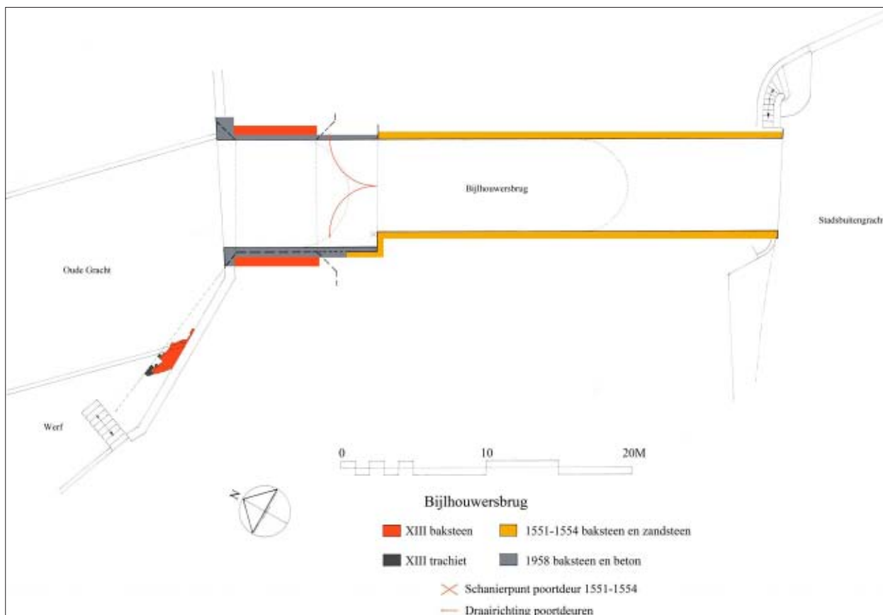
Afb. 4.1 Fasering van de Bijhouwersbrug op basis van de opmeting uit 1997, aangevuld met de waarneming uit 2012 (tekening: H. Hundertmark).
